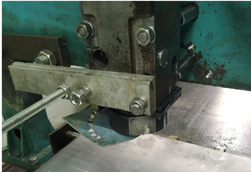
Рисунок 80 – Поворотный механизм для регулирования угла \alpha
