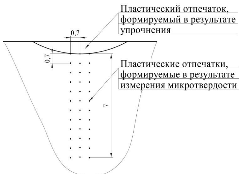
Рисунок 34 – Схема измерения микротвердости под отпечатком
