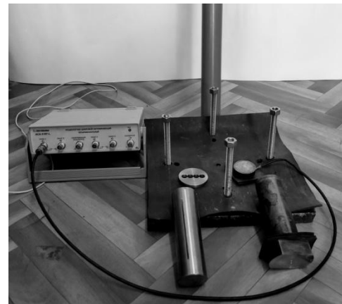
Рисунок 21 – Схема экспериментального стенда (а), стенд в сборе (б) и в разобранном состоянии (в): 1 – основание; 2 – виброгасящий элемент; 3 – образцы; 4 – пьезоэлектрические датчики; 5 – инструменты; 6 – пластина; 7 – боёк; 8 – волновод; 9 – сепаратор; 10 – направляющая труба; 11 – винты для статического поджатия
