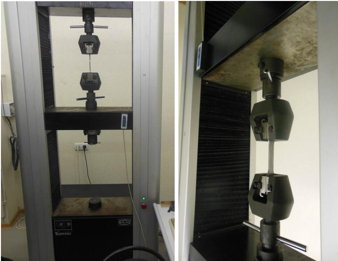
Рисунок 3 – Общий вид разрывной машины WDW-100 (а) и испытываемый образец, закрепленный в захватах (б)
